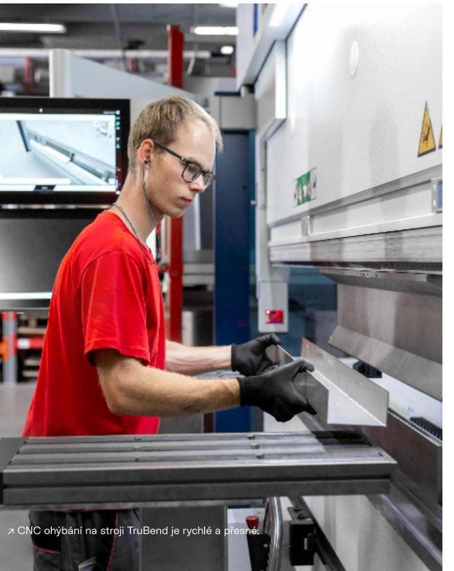
↗ CNC ohýbání na stroji TruBend je rychlé a přesné.
