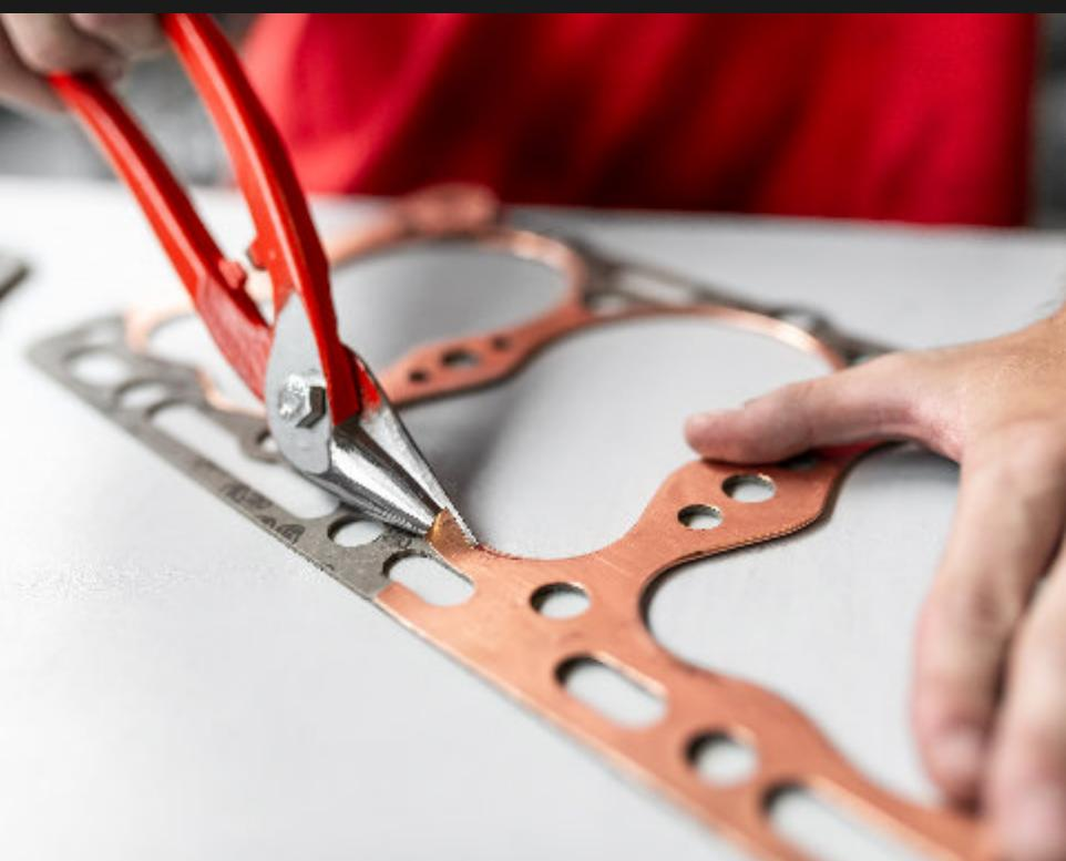
↑ Zakázková výroba s vysokým podílem ruční práce je nezbytná v případě výroby těsnění a dílů, ke kterým už neexistuje výrobní dokumentace. Což je u veteránu běžný problém, který vyřešíme.
