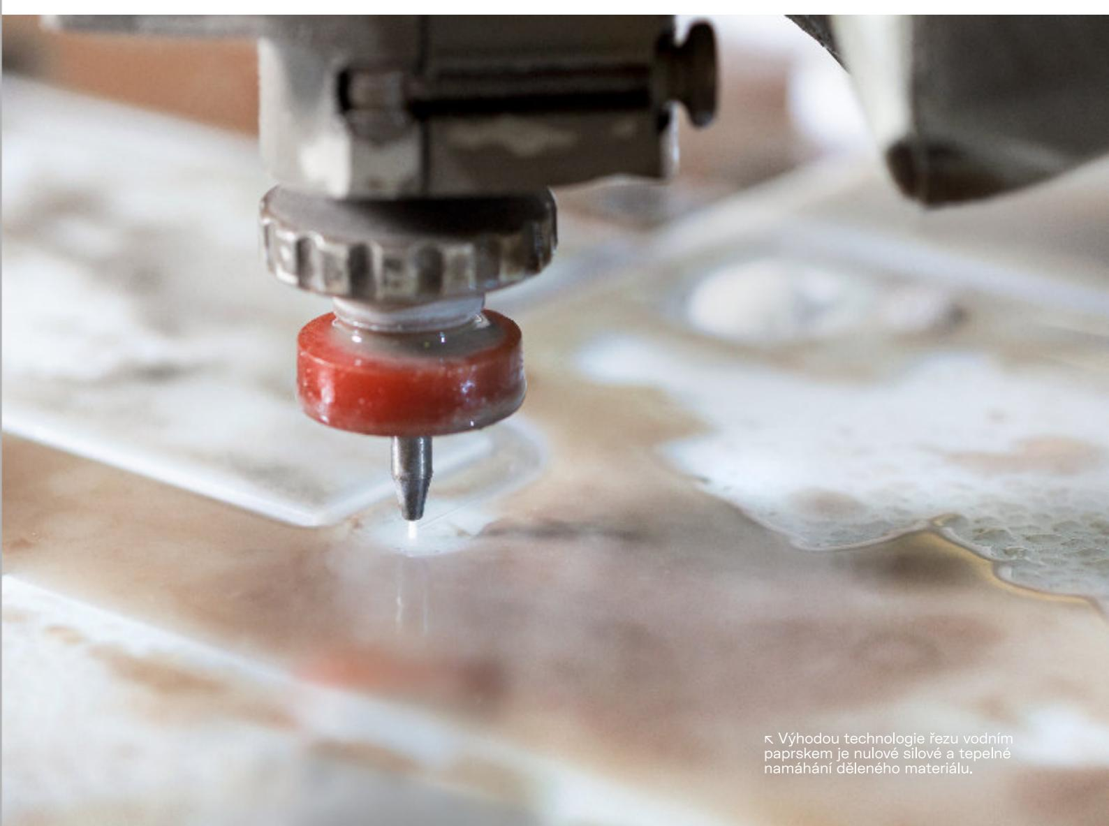
↖ Výhodou technologie řezu vodním paprskem je nulové silové a tepelné namáhání děleného materiálu.
